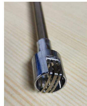
Obr. 3 - Povrchový teplomer s viditeľným meracím spojom
