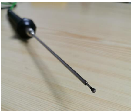
Obr. 2 - Povrchový teplomer so zaliatým meracím spojom
