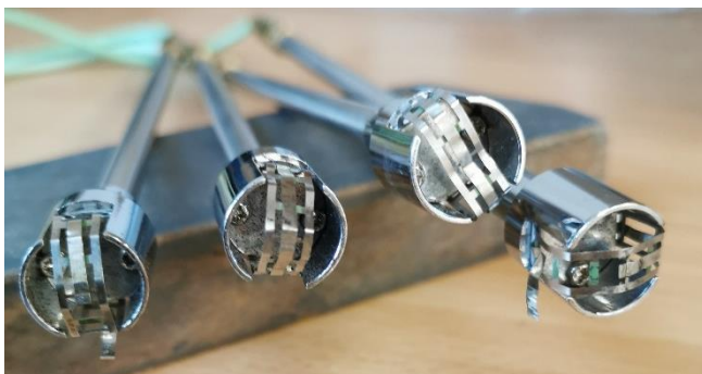
Obr. 4 - Poškodené povrchové teplomery
